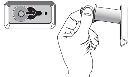
3. Una vez que se hayan quitado los 4 pernos, descarte los pernos y los espaciadores. Luego retire el cable de suministro de energía por la abertura del panel trasero y cierre el orificio con la tapa adjunta.
