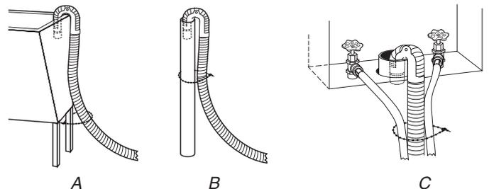
Si los grifos de la lavadora y el tubo vertical de desagüe están empotrados (vea la ilustración C), ponga el extremo en forma de gancho de la manguera de desagüe en el tubo vertical. Enrolle el fleje rebordado con firmeza alrededor de las mangueras de entrada del agua y de la manguera de desagüe.
