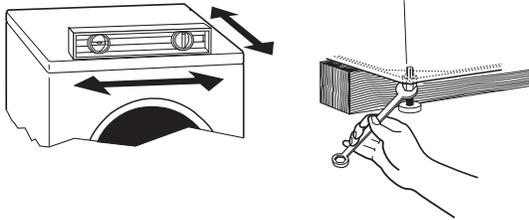
Si la lavadora está contra la pared, mueva la lavadora ligeramente hacia afuera antes de inclinarla hacia atrás. Si la lavadora no está nivelada, primero apunte la parte frontal con un bloque de madera y regule las patas según sea necesario, después apunte la parte de atrás y regule las patas según sea necesario. Repita este paso hasta que la lavadora quede nivelada.
