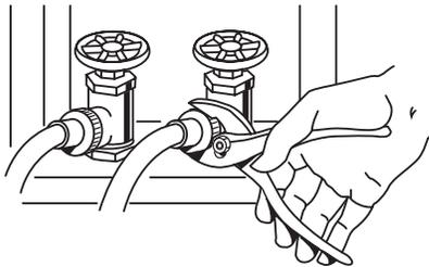
**NOTA:** No apriete demasiado. Se pueden dañar los acoplamientos.
